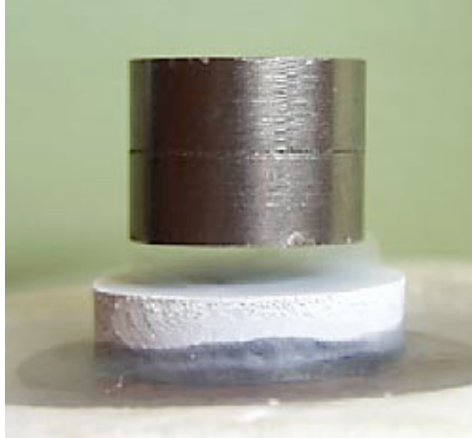
Fig. 5 . Au dessus d'une pastille en oxyde de cuivre, yttrium et baryum ( YBaCuO ) refroidie à 77 K grâce à de l'azote liquide, un aimant permanent de 50 mm de diamètre lévite spontanément. C'est une conséquence de la supraconductivité de cet oxyde de cuivre qui en fait un diamagnétique parfait, c'est-à-dire un matériau qui exclut tout champ magnétique (photographie du groupe de Robert Tournier, Laboratoire de cristallographie Grenoble)
