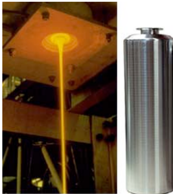
Figure 11.4. Les conteneurs de déchets vitrifiés. Vue d'une coulée de verre à gauche et conteneur CSD-V à droite. Lors du retraitement, les produits de fission et les transuraniens sont « vitrifiés », c'est-à-dire incorporés dans un verre au borosilicate en fusion. Le mélange est coulé à 1150 °C dans des conteneurs étanches en acier inoxydable appelés CSD-V (Conteneur Standard de Déchets-Vitrifiés). Leur hauteur est de 1,35 m, leur diamètre de 0,43 m, et leur volume utile de 150 litres. Le poids moyen d'un conteneur CSD-V est de 490 kg soit 90 kg de conteneur et 400 kg de verre solide (dont 14 % de produits de fission). Un conteneur CSD-V correspond à environ 1,3 tonne de combustible retraité. Il se caractérise par un dégagement de chaleur important, en moyenne 2,5 kilowatts par conteneur, au moment de sa production. Les conteneurs sont entreposés en puits ventilés, pour leur refroidissement, sur les sites de production de Cogéma à La Hague et Marcoule. (documents ANDRA)
