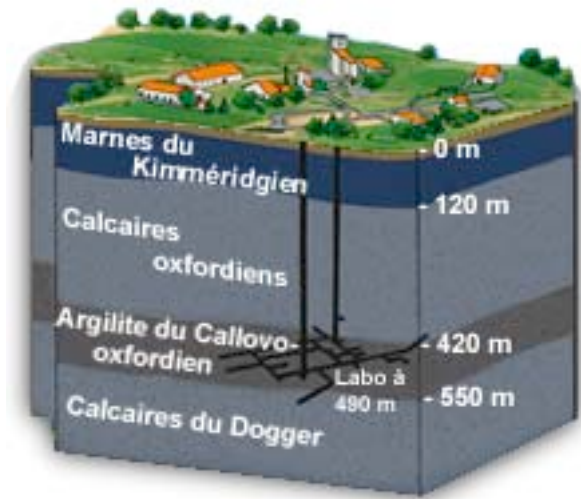
Figure 11.3. Vue schématique du site du laboratoire de stockage de l'Est de la France. (document ANDRA)
