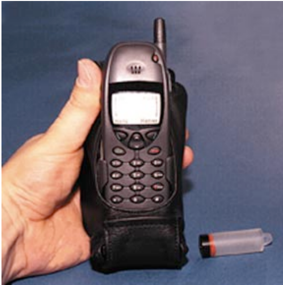
Figure 11.5. Un téléphone portable à micropile à combustible (Energy Related Devices) avec son réservoir de méthanol amovible, et le prototype Honda FCX-V3 équipé d'un réservoir d'hydrogène sous pression.
